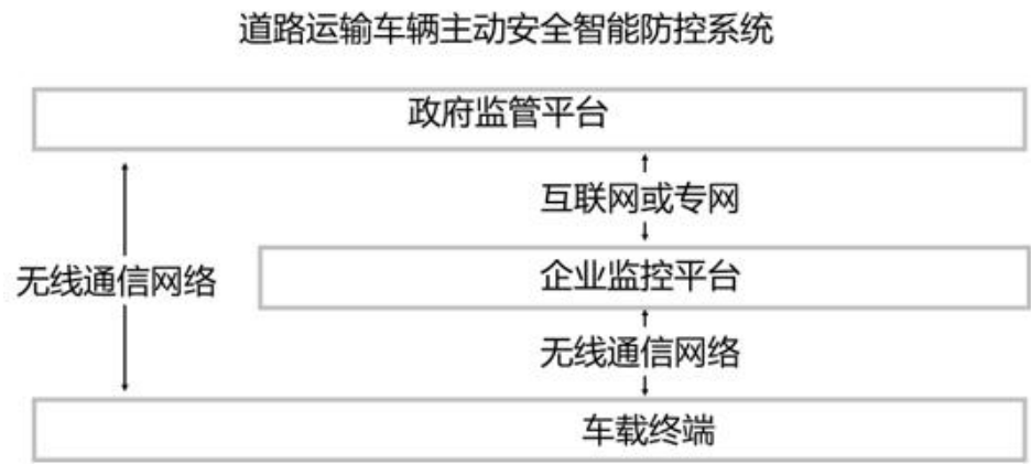
图 1 道路运输车辆主动安全智能防控系统架构
